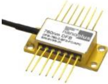
Корпус "бабочка" 14-ти контактный с интегрированным ТЕС и термистором Сокеты
