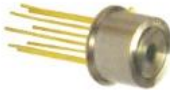
TO 5 с интегрированным ТЕС и термистором
